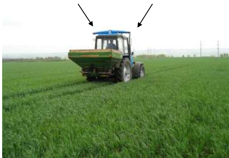
Рисунок 28. Разбрасыватель «AMAZONE ZA-M», оснащенный N-сенсором «Яра» для сканирования посева
