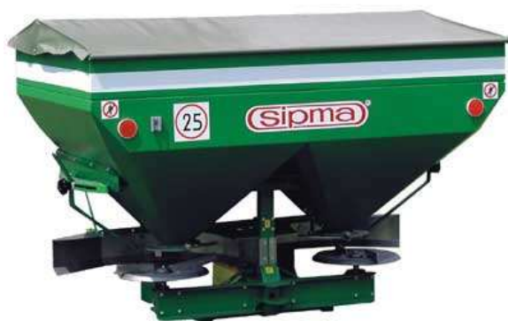
Рис. 5. Разбрасыватели минеральных удобрений N-049 и N-060 (двудисковые, объёмом от 400 до 2000 кг, предназначенные для поверхностного внесения удобрений. Рабочая ширина разбрасывания – 10 – 28 м.
