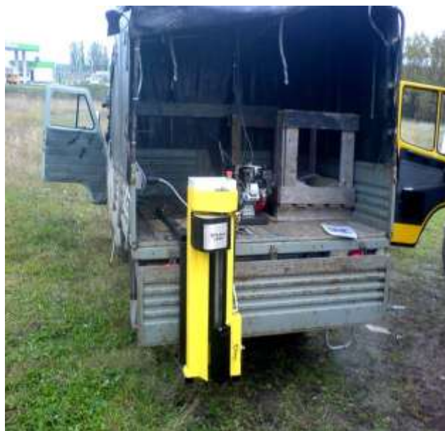
Рисунок 26. Пробоотборник почвы Wintex 1000
